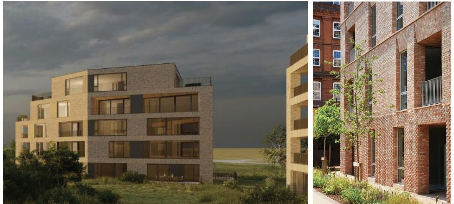
Voorbeeld van een horizontale gevelcompositie met loggia's. Een horizontale compositie oogt minder stedelijk dan een verticale compositie. De structuur leent zich voor een meer gesloten gevel in de buitenrand en een meer open gevel aan de naar de wijk toegekeerde gevel.
