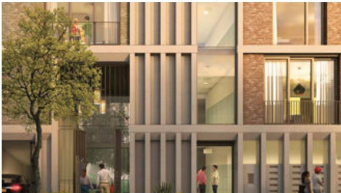
Voorbeeld van verfijning in de gevelcompositie. Met horizontale en verticale belijning en gemetselde terugliggende puivlakken. De structuur leent zich zowel voor de meer gesloten gevel in de buitenrand als de meer open gevel aan de zijde van de wijk.
